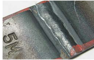
Saldatura MAG di lamiera di acciaio spessore mm 0,8 in testa a testa.
