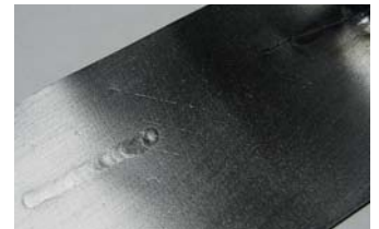
Saldatura TIG TIPO LASER su lamiera sovrapposte spessore mm 0,8.
