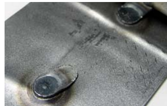
Punti di saldatura con TIG su lamiera sovrapposte e prova di strappo.
