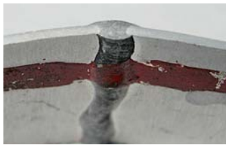
Penetrazione con saldatura MIG ad arco pulsato di lamiera di alluminio spessore mm 0,8 in testa a testa.
