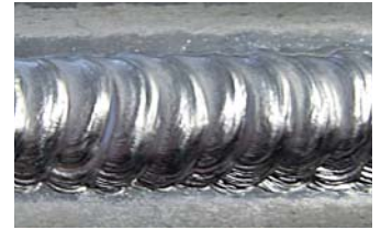
Saldatura MIG ad arco pulsato di lamiera di alluminio spessore mm 0,8 in testa a testa.
