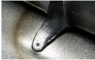
Prova di strappo di saldatura TIPO LASER.
