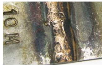
Saldobrasatura MIG con filo CuSi3 di lamiera di acciaio spessore mm 0,8 in testa a testa.
